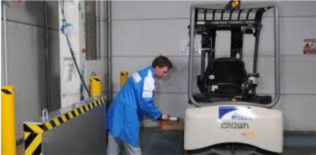
A estação da Air Liquide vai fornecer hidrogénio a uma pressão de 350 bar e permitirá encher um depósito em 3 minutos. Em alternativa às baterias elétricas, as pilhas de combustível oferecem uma flexibilidade e uma produtividade acrescidas, tendo em conta a maior autonomia de utilização e o menor tempo de paragem para recarga.
