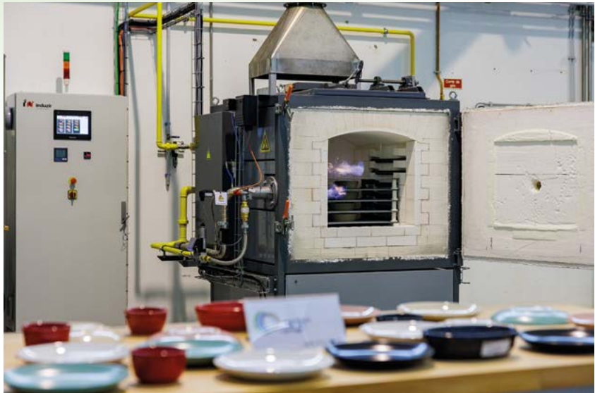
▲ Figura 1: Forno híbrido intermitente instalado no laboratório hipocarbónico do CTCV
