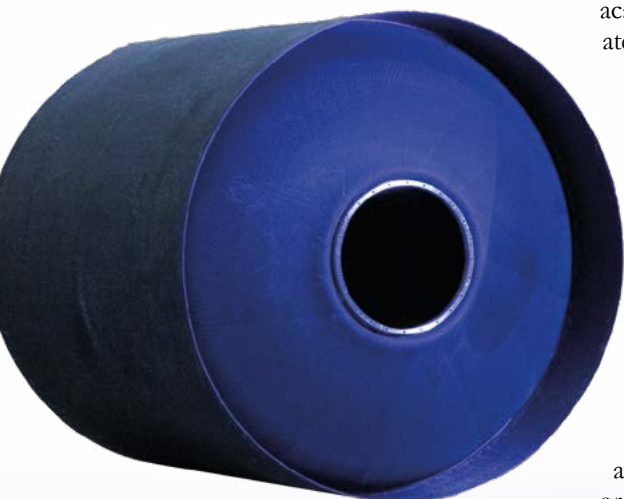
▲ Tanque principal do veículo suborbital.
