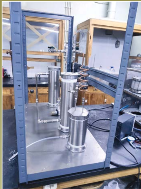
◀ Reator laboratorial de metanação
