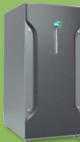
esta de aproximadamente até 55% (eficiência na conversão elétrica). O equipamento dispõe dum circuito secundário que permite aproveitar o calor gerado (máximo 800W) permitindo ter uma eficiência global (térmica + elétrica) em torno dos 85%, se a operar com gás natural (Valor Calorífico Inferior do Gás natural, aproximadamente 10,72kwh/m<sup>3</sup>). A célula funciona por reforma do gás natural para uma mistura rica em hidrogénio.
