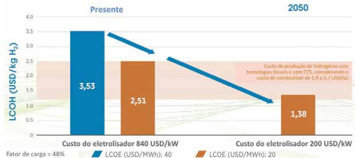
Figura 6 - Custos do hidrogénio para diferentes preços da eletricidade e do CAPEX para o eletrolisador com uma capacidade de carga de 48% (IRENA, 2019)
