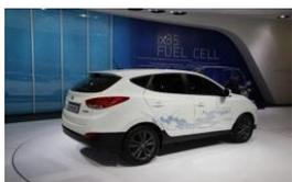
O anúncio surpreendeu e veio directamente da sede da Hyundai: a empresa vai lançar o primeiro veículo do mundo que anda a hidrogénio e que vai ser fabricado em série. O automóvel está equipado com dois tanques de armazenamento de hidrogénio, e que têm uma capacidade total de 5,64 kg e um abastecimento permite uma autonomia até 588 quilómetros.
