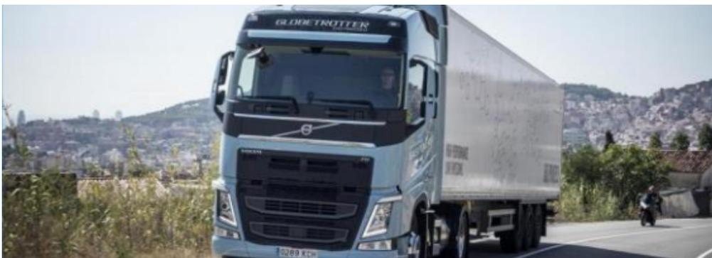
O camião de GNL da Volvo, com injeção direta de alta pressão (HPDI), registou emissões de tanque para roda 14% menos em comparação com o veículo a diesel testado que apresentou as menores emissões de GEE.
